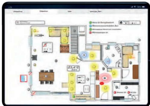
Steuerung Ihres Smart Home über eine Grundrissvisualisierung der Wohnfläche: Die Darstellung der zu steuernden Geräte, Sensoren, usw. erfolgt mit vorgefertigten Visualisierungselementen, welche passend auf dem Grundriss platziert werden können. Leuchten können durch einfaches Antippen AN und AUS geschaltet werden. Bei dimmbaren Lampen erscheint ein weiterer Bediendialog als Slider.
